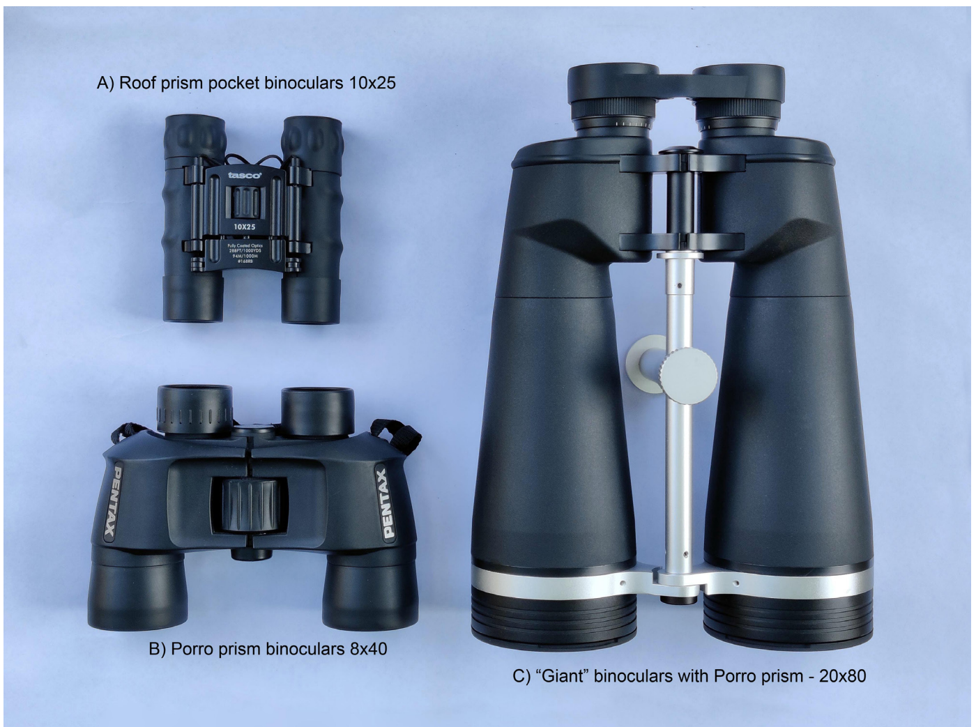
Ffigur 5 Binocwlars amrywiol, A) prism to, B) prism Porro, C) binocwlars "anferth"
